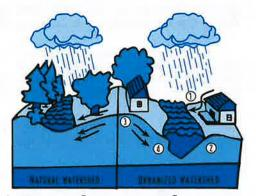
() INCREASED RUNDFF (2) STREAMBANK EROSIDN (3) DECREASED INFILTRATION (4) DECREASED GROUND WATER FLOW TO STREAM
